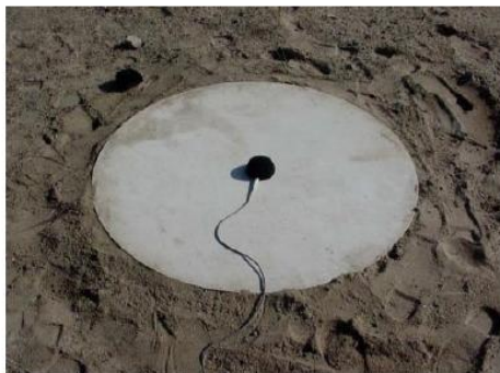
Slika 8. Pritrditev mikrofona na trdo refleksijsko podlago
