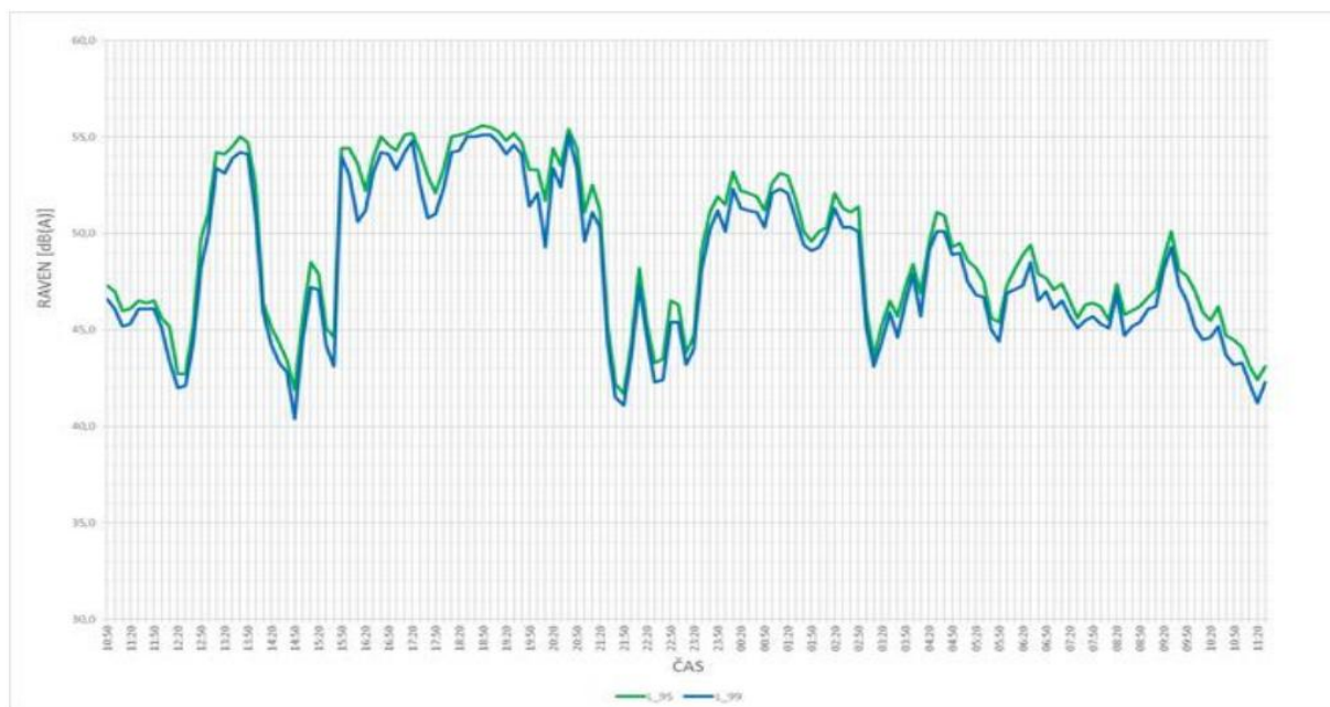
Slika 9. Diagram časovnih sprememb izmerjenih ravni zvočnih tlakov
